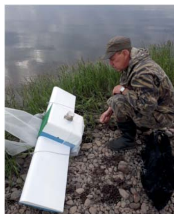
Рис. 3. Пробоотборник «Мантa», сконструированный для сбора поверхностных вод с целью анализа на микропластик
